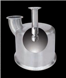
Vor der Demontage wird das Andocksystem mittels einem CIP-Topf mit festem oder beweglichem Waschkopf befeuchtet, und somit alle staubförmigen Partikel gebunden. In den meisten Fällen aber werden die zu reinigenden Teile (Aktivklappe mit Balg) mittels Sauggriff aus der Station entnommen, ohne dass auch nur ein Schlauch oder Kabel von den Antrieben oder Steuerung abgeklemmt werden muss.
