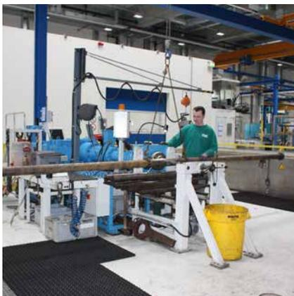
Extruder mit Stator für die Ölförderung
