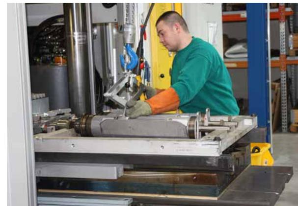
Spritzgussmaschine für iFD-Stator®
